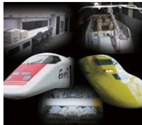
配备的检测装置和用于检查的新干线（“East i”和“Dr. Yellow”）
