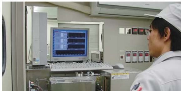
在工厂的检查车间进行出货前调试的PCB监测装置“CP-2000P”。技术人员正在对每一台装置进行着调试。
